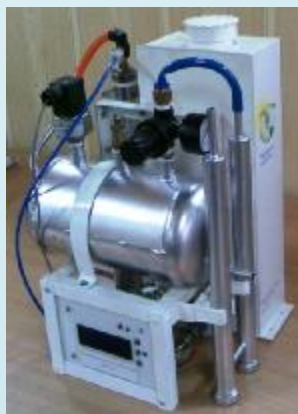
طراحی و ساخت سامانه استحصال آبی هیدروژن از سدیم بور هیدرید در کشور دانشگاه صنعتی نوشیروانی بابل
