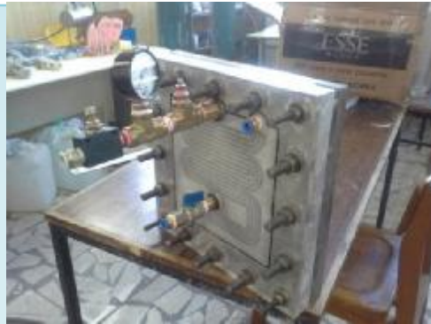
تست سیستم جداساز یکپارچه روی سامانه آزمایشگاهی
