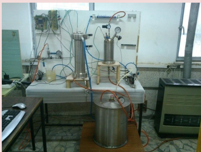
راکتور ساخته شده تولید هیدروژن از آلومینیوم و محلول سود در گروه پژوهشی فناوری پیل سوختی
