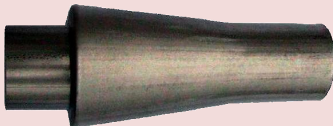
۳- لوله پله‌ای مخروطی شکل داده شده با گوشه تیز (فولاد زنگ نزن ۳۰۴)
