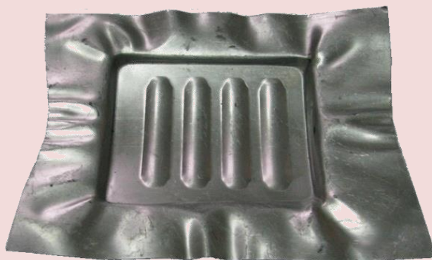
۵- قطعه آلومینیمی تولید شده بر روش هیدرو فرمینگ (آلیاژ آلومینیم سری ۶۰۰۰)
