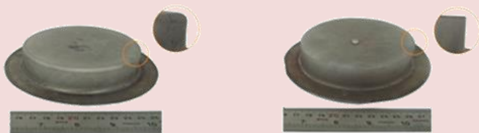
۷- قطعات استوانه‌ای از جنس آلومینیم، تولید شده با روش شکل‌دهی با گاز
